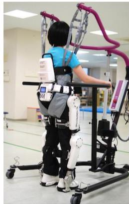
HAL を装着し各関節の軸が適合するように調整を行います。
